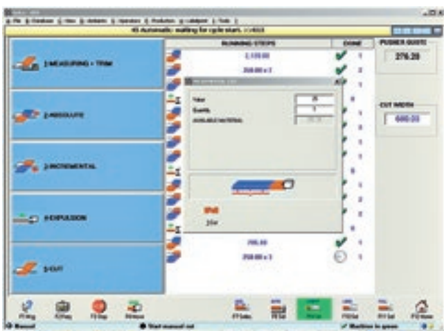
快速、简单执行切割和开槽的交互程序，即使是在再次循环的面板上也能轻松操作。
